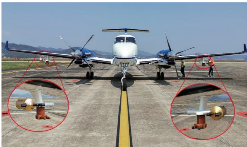
图 D.2 云粒子谱仪安装实例
